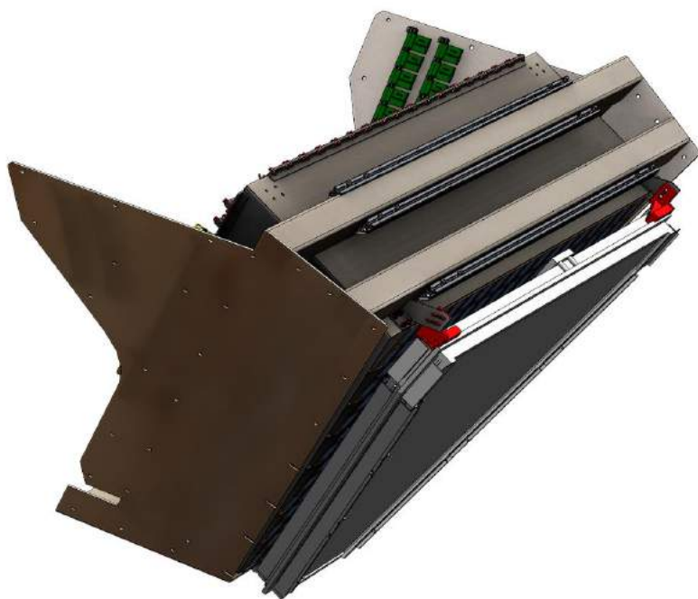
Rys 8: Widok detektora RPC umocowanego na kontenerze modułów szkła ołowiowego.
